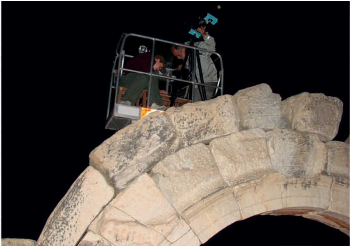
1 Nachtarbeit mit dem hochauflösenden Streifenlichtscanner
